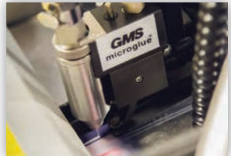
Las válvulas HP garantizan una aplicación limpia a altas velocidades con mínimo mantenimiento
