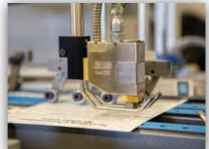
Equipado con aplicadores de hot melt eléctricos HM-100
